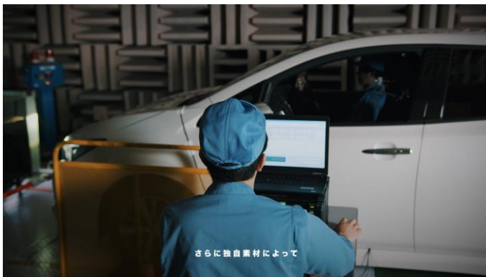
さらに独自素材によって 無響室で実車評価を行うシーン
